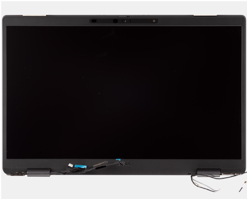
Figure 1. Assemblage d'écran avec câbles d'antenne
